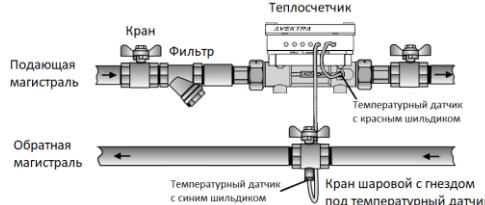
Рисунок 1 - Монтаж теплосчётика в подающую магистраль
