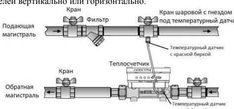
Рисунок 2 - Монтаж теплосчётика в обратную магистраль
